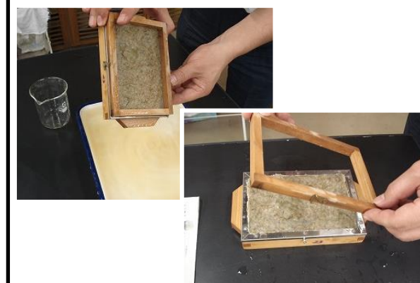
水をよく落とし、上の枠をはずす
