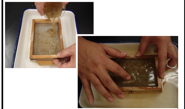
木枠に紙のもとを入れ、水に浮かべて、枠全体にうすく広げる
