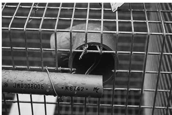
図 2. 混獲防止罠の誘因エサの設置部分の構造: かご罠の金網部を一部カットして, 塩ビ管継手を取り付ける.
