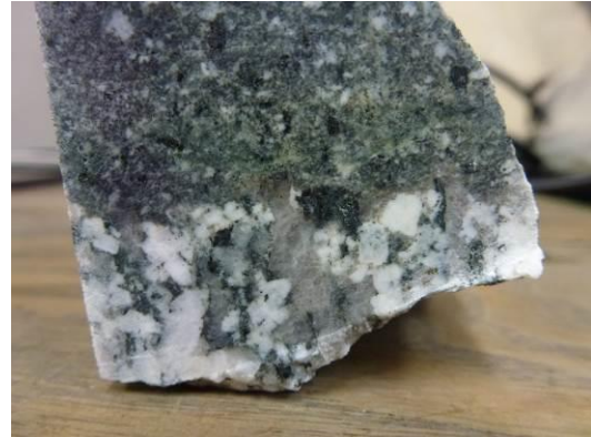
図 28. No. C (転石) に認められる細粒 diorite と粗粒 granite の接触部.
