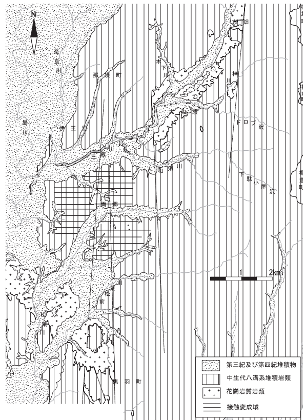
図 33. 八溝山地伊王野地域の地質図。1/50,000 表層地質図「大田原・埜」(栃木県, 1989) より。
