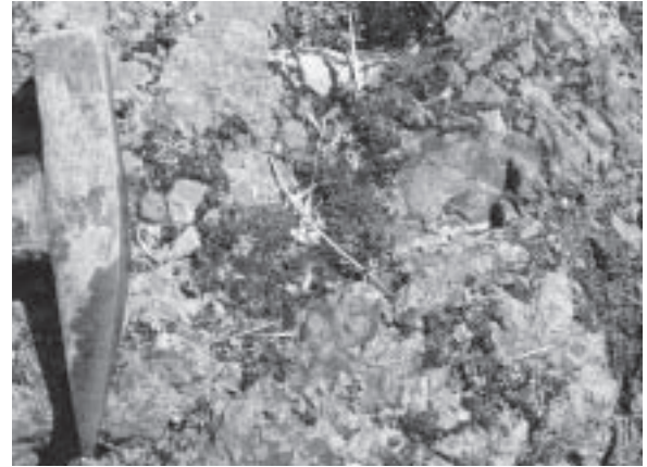
図 19. 谷地下地域の流紋岩礫の少ない礫岩. 長径数 cm の亜円礫～角礫で構成され、大部分が八溝層群の砂岩の礫で流紋岩の礫はほとんどみられない。礫支持であり、層理はみられない。基質は砂岩の破碎した岩片と結晶片である。
