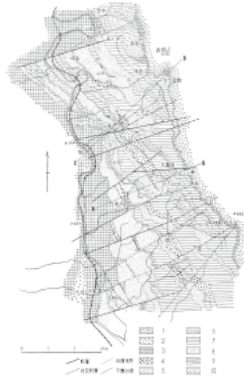
図4. 大子-山方地域の第三系岩相図 (神谷, 1969). 1 集塊岩, 2: 安山岩, 3: 頁岩, 4: 礫岩, 5: 白色凝灰岩, 6: 角礫質凝灰岩, 7: 砂岩・頁岩互層, 8: 砂岩を主とする部分, 9: 基盤岩類 (鶯子層群), 10: 深成岩類.
