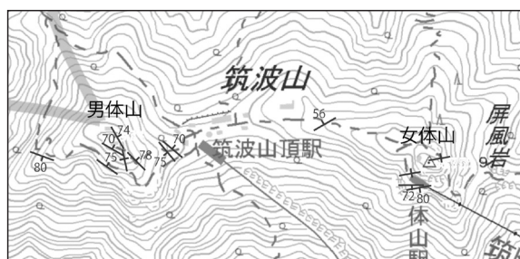
図 6. 筑波山山頂付近でのハンレイ岩体の層状構造の走向傾斜。
