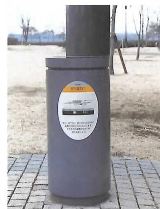
地上、地下3m、地下15mの3か所に温度計が取り付けられています。地上と地下浅い所と地下深い所と、どのくらい温度が違うのか比べてみましょう。
