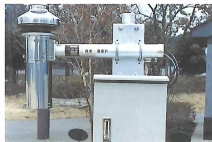
自然発見工房周辺の気温・湿度・気圧、そして雨量が一度に、測定できる装置が、今年新しくお目見えしました。測定結果は、自然発見工房展示室の中の記録装置に1日24時間、1年365日続けて記録されています。
