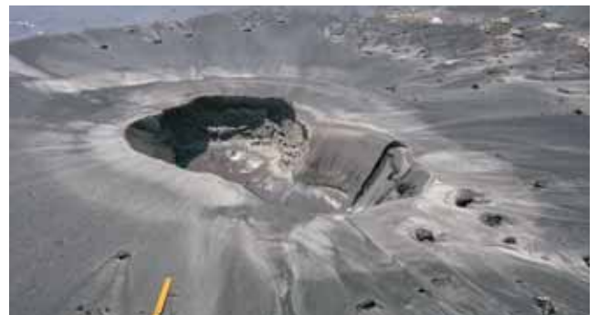
液状化現象で生じた噴砂（日立市）
