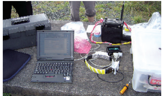
GPS首輪の初期化とセッティング。パソコンの専用ソフトウェアによって測位スケジュールなどさまざまな設定が可能になっている。
